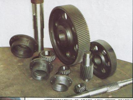
APPROXIMATELY 30 YEARS LOW SPEED BEARING LIFE, LOW SPEED SHAFT IS 61/4" UNDER GEAR, HIGH SPEED GEAR 171/2 x 31/2, LOW SPEED GEAR 29 x 61/4
